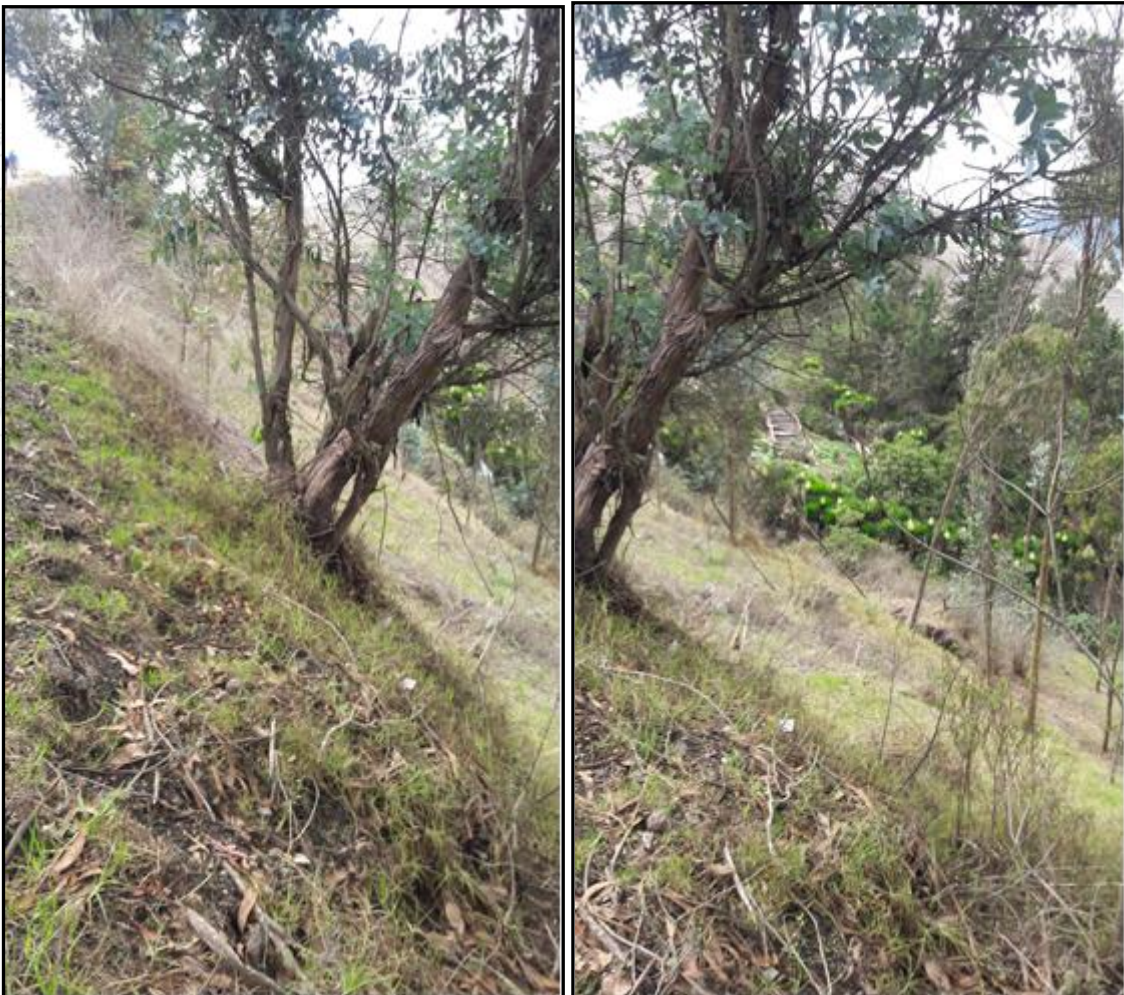
Imágenes 7 y 8: Basculamiento de los arboles por el empuje de la masa de suelo.
